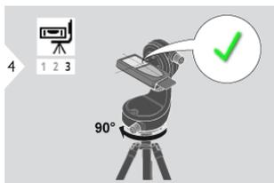
ディスプレイに表示される手順でデバイスを時計回りに $90^\circ$ 回転、OKの表示でレベリング終了
